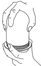
4 ランプを交換して逆手順で本体を持ってグローブとセードとガードを取り付ける。
