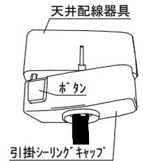
5 コードの長さを調整する場合はコード調整器を使用して調整する。
