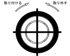
2 本体を持ってガードを回して取り外し、別梱包の専用セードを通しガードを回して取り付ける。
