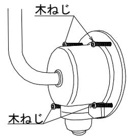
4 ランプを付け、ガードとグローブが組み合わさった状態のガードを本体に回して取り付ける。
